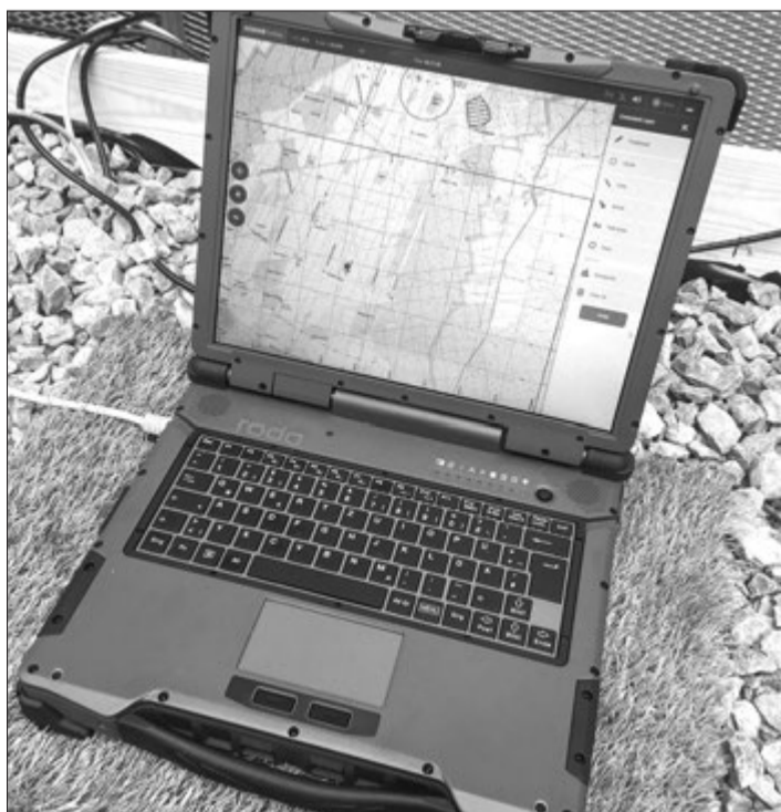
Beispiel für einen ruggedized Laptop, der in den Fahrzeugen der VJTF (L) 2023 mitgenommen wird, um das Battle Management System von Systematic in analoger Umgebung rechtzeitig zur Verfügung zu stellen. Foto: BS/Dorothee Frank
