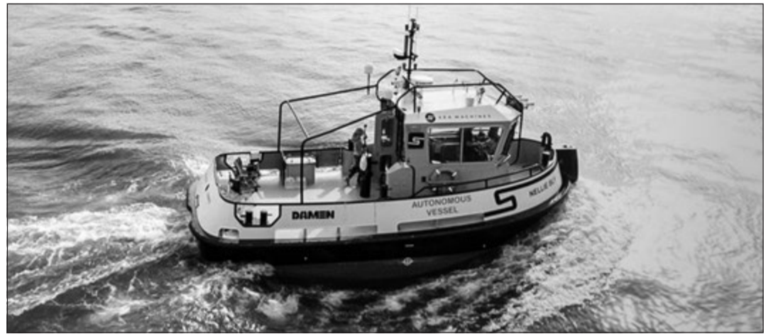
Dieser Schlepper startete im September zu einer fast 2.000 km langen Fahrt die dänische Küste entlang, welche das unbemannte Schiff autonom, also ohne menschlichen Einfluss, durchführen soll.
