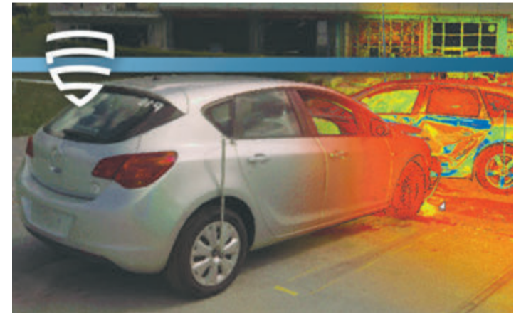
Mithilfe des sogenannten forensischen digitalen Zwillings ist es möglich, den Ist-Zustand eines Unfallortes für immer digital, exakt und dreidimensional festzuhalten. Auch ist immer wieder eine Besichtigung des Ortes möglich. Foto: BS/Hexagon
